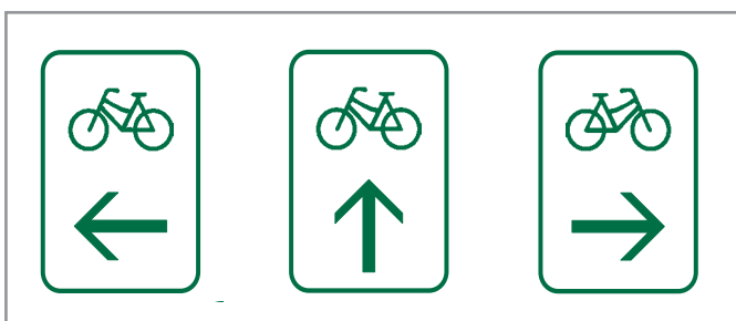
Abbildung 26: Zwischenwegweiser mit Isopeil in den Standardrichtungen
