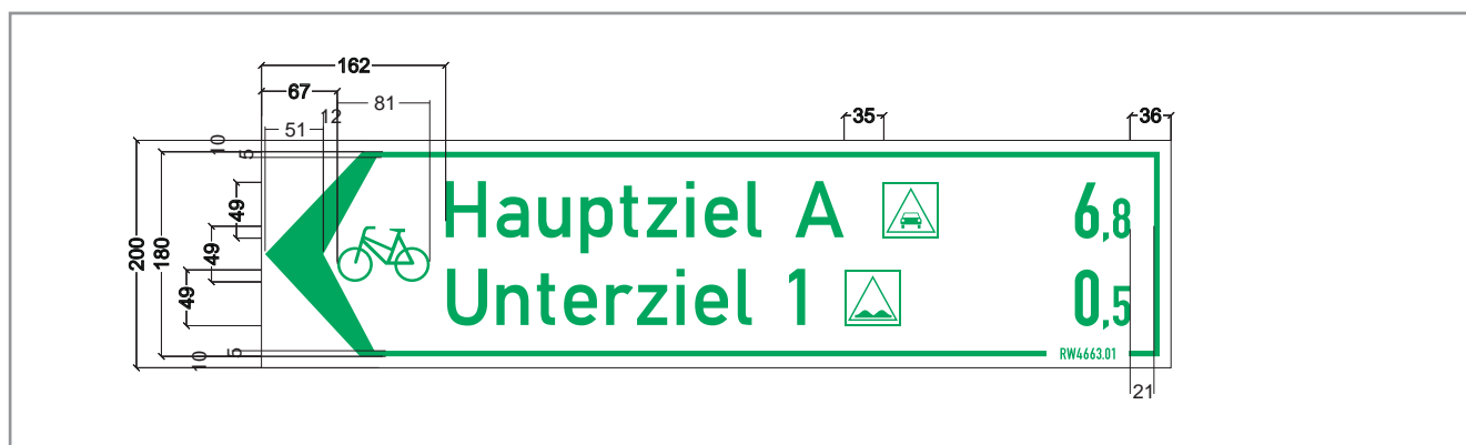
Armwegweiser mit Bemaßungen für die Größe 800x200 mm
