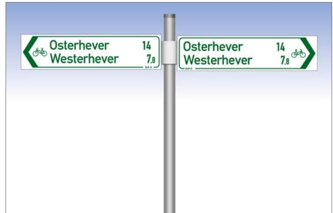
Abb. 5.2.0.1. Richtungsangaben auf Armwegweisern mit integriertem Rahmenpfeil
