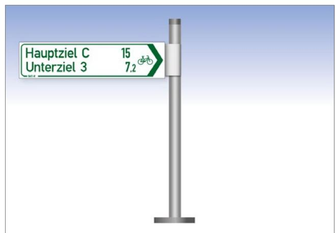
Abb. 8.0.0.2. Ausnahme für besonders beengte Verhältnisse - Armwegweiser mit der Seite der Pfeilspitze am Pfosten montiert
