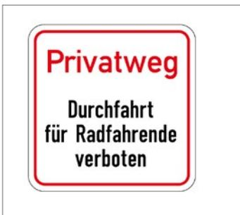
Abb. 5.5.0.5. Beispiel-Entwurf Sonderschild für Privatwege im Format eines Zwischenwegweisers (250 x 250 mm oder 300 x 300 mm)
