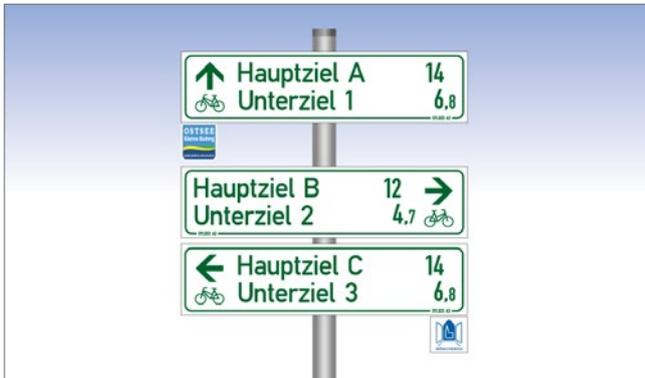
Abb. 4.3.0.3. Aufgelöster Tabellenwegweiser mit Einschubschildern
