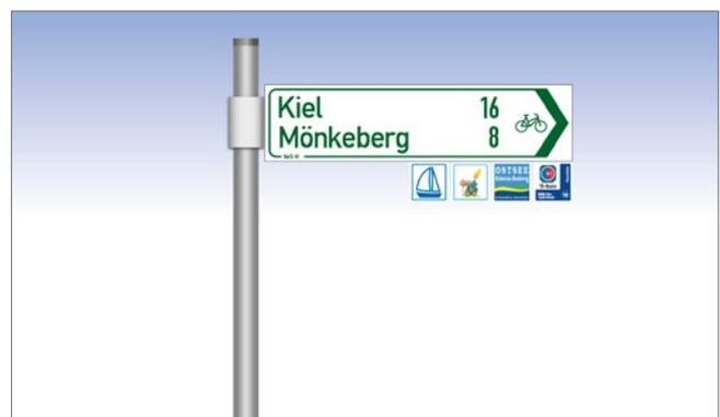
Abb. 4.3.0.2. Armwegweiser mit Einschubschildern
