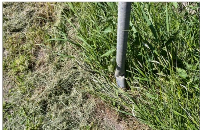
Abb. 10.0.0.4. Durch Mähwerk beschädigter Pfosten
