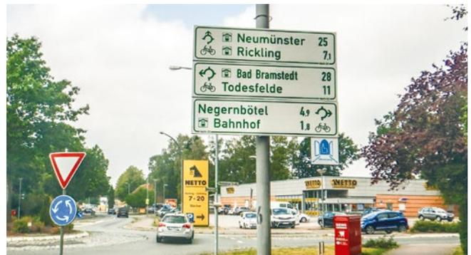
Abb. 4.1.0.3. Tabellenwegweiser mit aufgelöster Aufhängung
