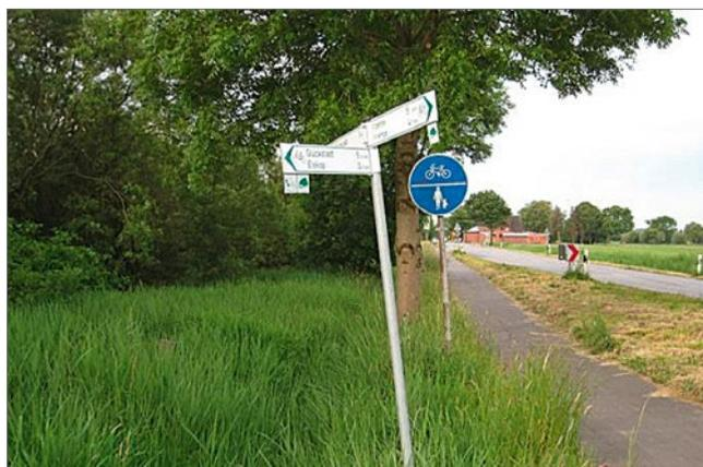
Abb. 7.4.0.1. Mast auf Grund einer fehlenden Verankerung schieft
