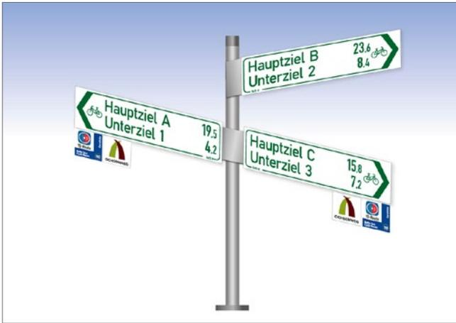
Abb. 8.0.0.3. Höhengleiche und höhenversetzte Anbringung von Armwegweisern mit Einschubschildern
