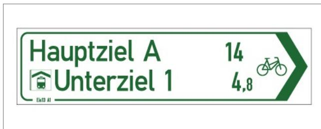
Abb. 5.4.2.1. Armwegweiser mit Zielpiktogramm
